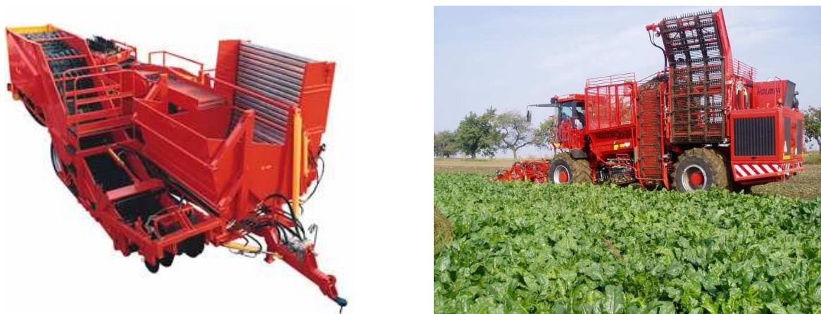
Obrázek 1.6 Sklízecí stroje na okopaniny – vlevo kombajn na brambory, vpravo sklízeč řepy
