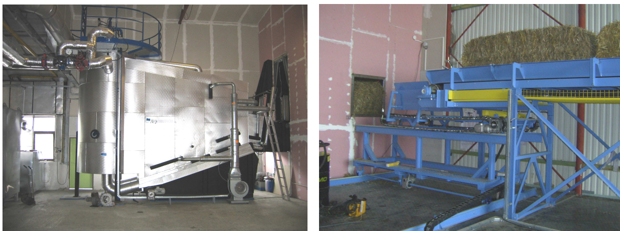
Obrázek 4.31 Kotel na spalování slámy a podáváč balíků
