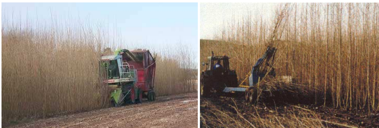
Obrázek 1.9 Sklízeče RRD – vlevo štěpkovací sklízeč, vpravo sklízeč ponechávající RRD na hromadě
