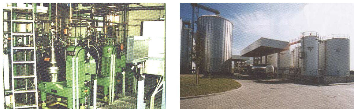
Obrázek 7.6 Technologie výroby FAME – vlevo talířové odstředivky, vpravo expediční místo výroby
