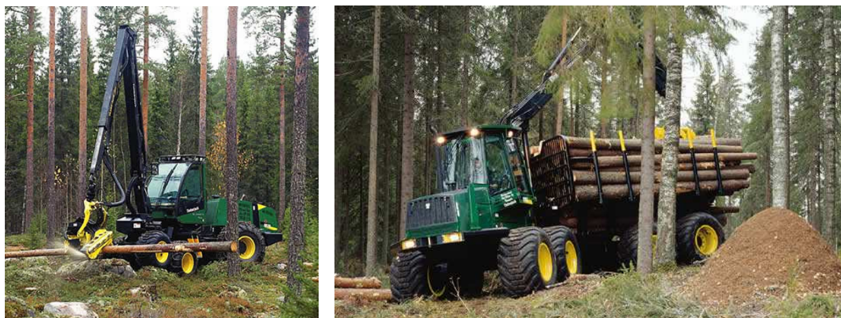
Obrázek 1.10 Těžební technika – vlevo Harvester, vpravo vyvážecí souprava
