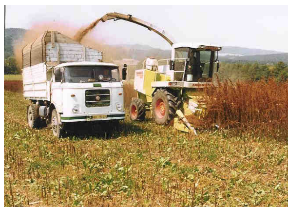
Obr. 14 Sklizeň energetického šťovíku řezačkou CLAAS Jaguar 820
