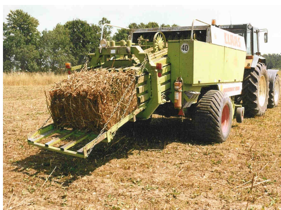
Obr. 13 Sklizeň energetického šťovíku lisem CLAAS Quadrant 1200
