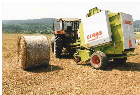
Obr. 12 Sklizeň energetického šťovíku lisem CLAAS Variant 180 rotocut
