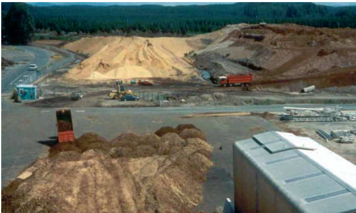
Obrázek 20 Dodávaná biomasa rozdělená do jednotlivých částí skladu podle vlhkosti [1]
