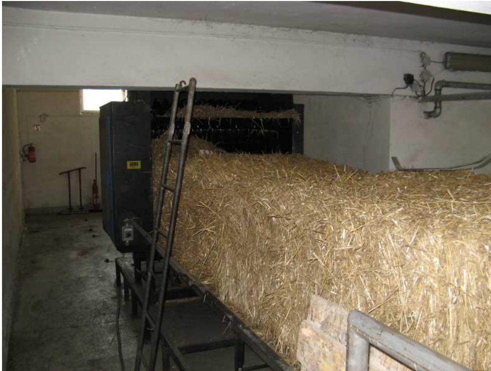
Obrázek 35 Řetězový dopravník balíků slámy
