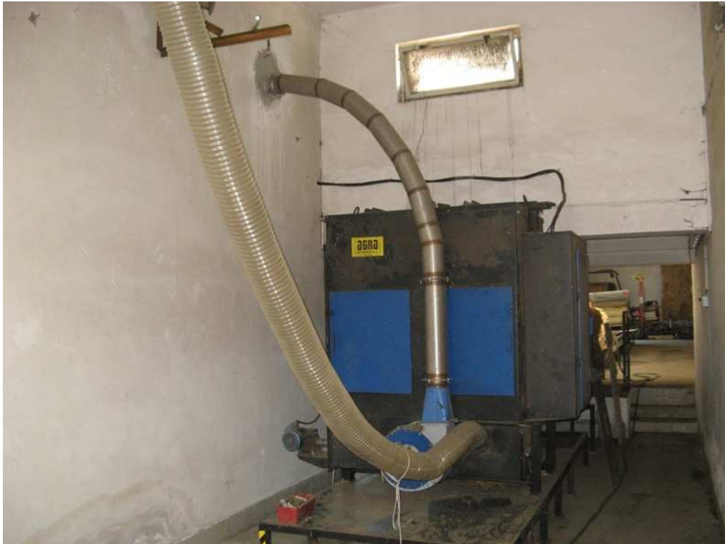
Obrázek 37 Pneumatická doprava rozdružené slámy
