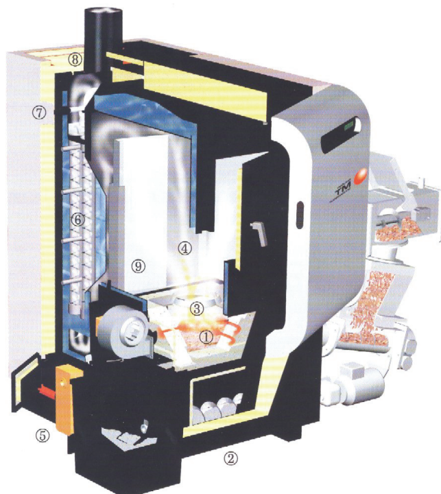
Obrázek 7 Plně automatizovaný kotel na dřevní štěpku a pelety [3]
