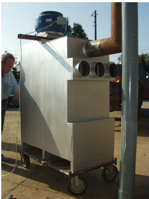
Obr. č. 10 Prototyp kotla – zadná strana
