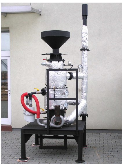
Obr. č. 1 Protiproudý zplyňovací reaktor se sesuvným ložem
