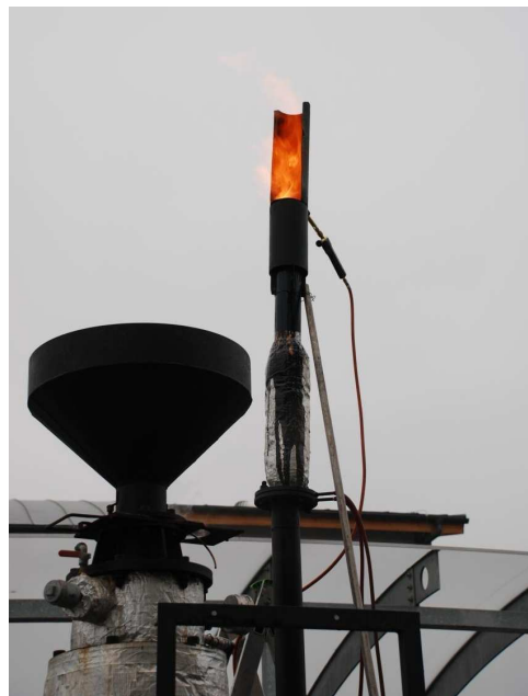
Obr. č. 4 Spalování dřevoplynu na polním hořáku
