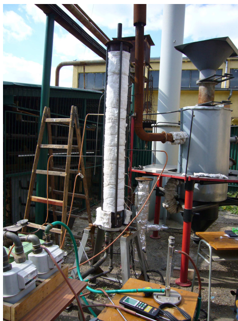
Obr. č. 6 Experimentálne zariadenie pre reburning s biomasou a splyňovač
