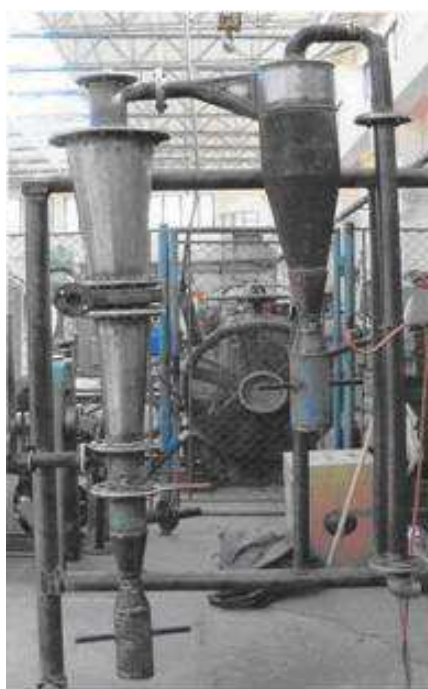
Obr. č. 2 Fotografia fluidného splyňovacieho zariadenia na KpaT
