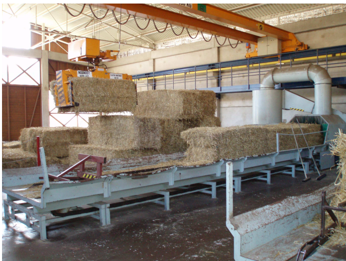
Obrázek 12 Skladiště slámy (rozdrůžovadla, mostový jeřáb)
