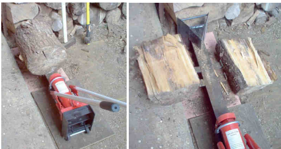
Obrázek 18 Štípačka polen s celým polenem (vlevo) a s naštípaným polenem (vpravo)
