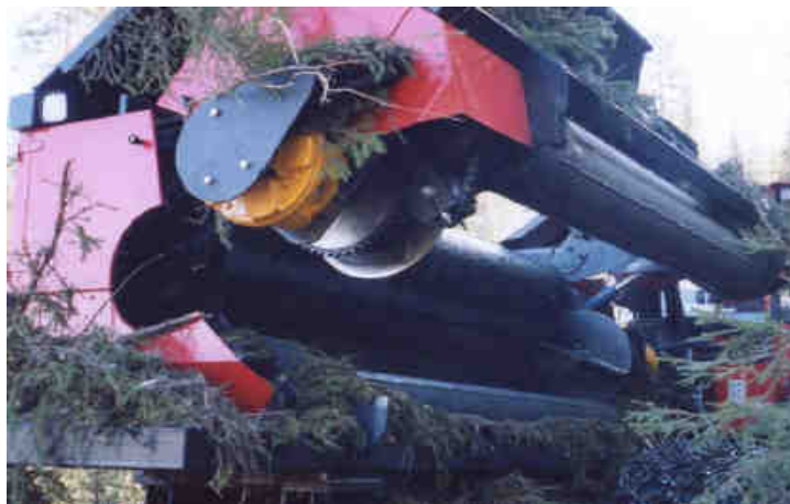
Obrázek 26 Detail systému svazkování [46]
