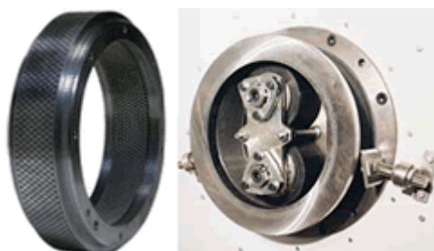
Obr. č. 18 Prstencový protlačovací matricový lis pro výrobu pelet
