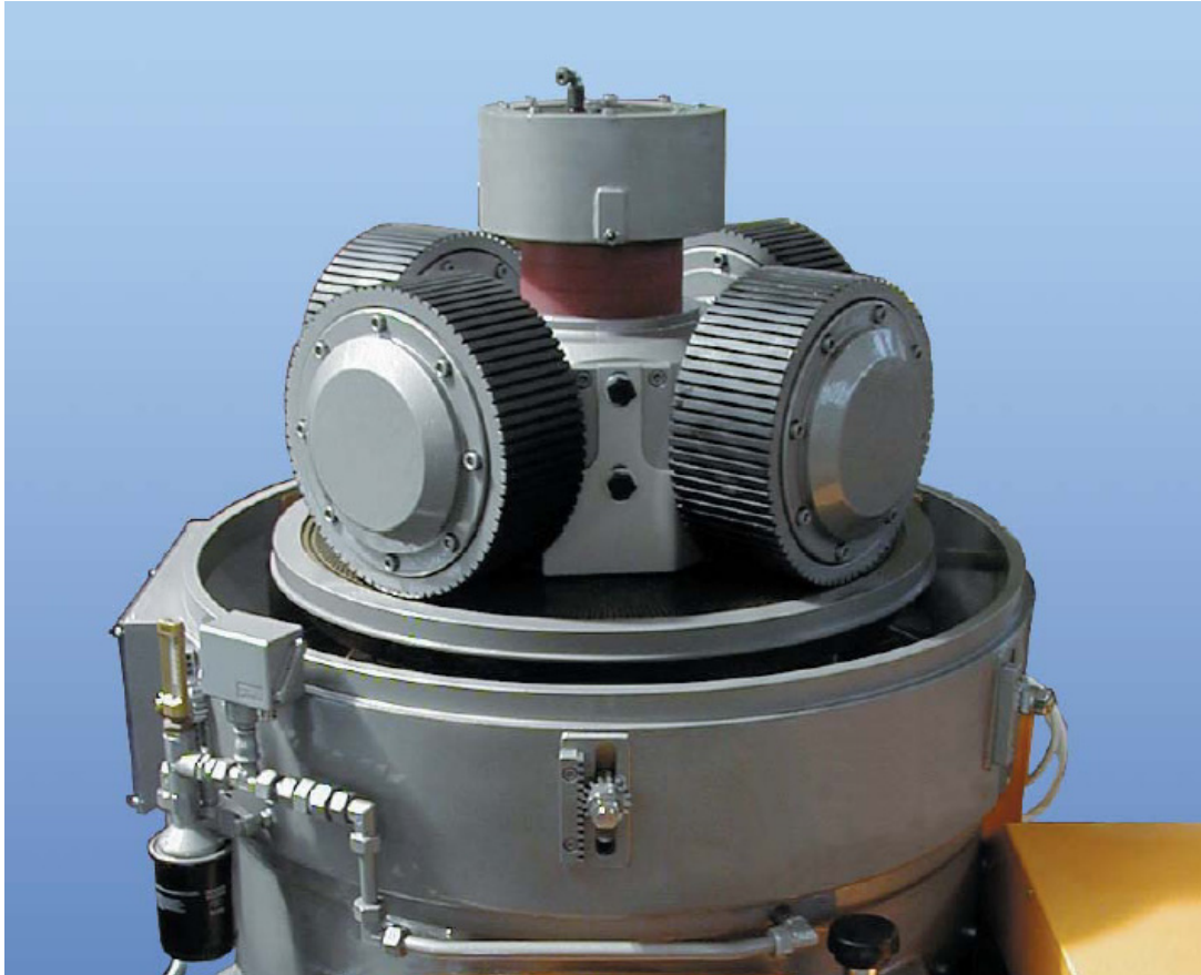
Obr. č. 23 Příklad prstencového lisu s plochou maticí
