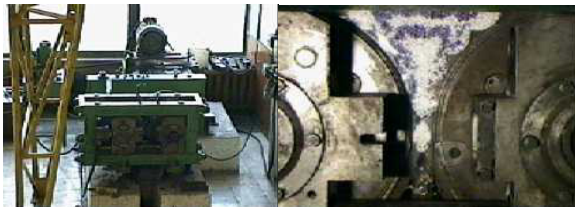
Obr. č. 21 Laboratorní válcový lis LPW-450
