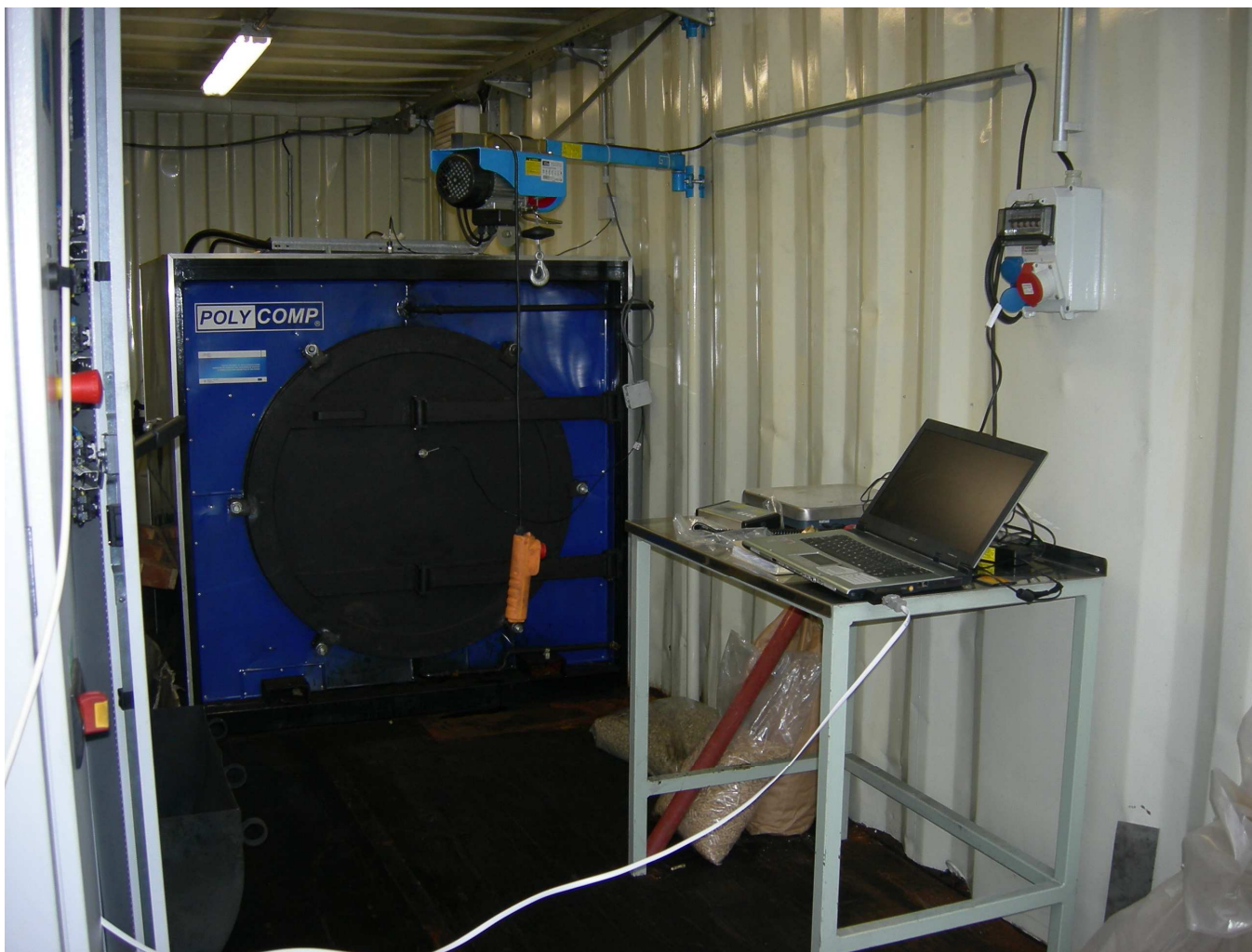
Termolýzní zkušební linka PolyComp – 50 kg/h
