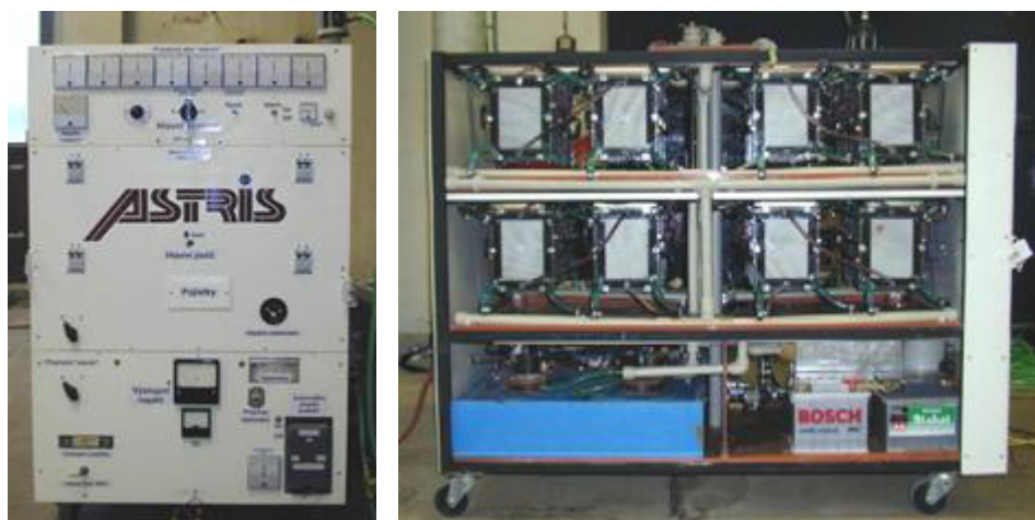
OBR. 3.21 KOGENERACNÍ JEDNOTKA S PALIVOVÝMI ČLÁNKY O VÝKONU 4 KW
