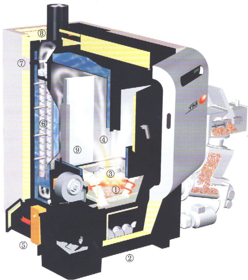
OBR. 3.14 PLNĚ AUTOMATICKÝ KOTEL NA ŠTĚPKY A PELETY
