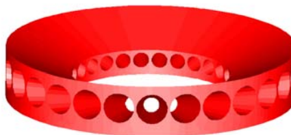
Obr. 4 Matematický model distribuční části roštu
