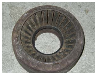
Obr. 2 Rošt s kuželovými roštnicemi
