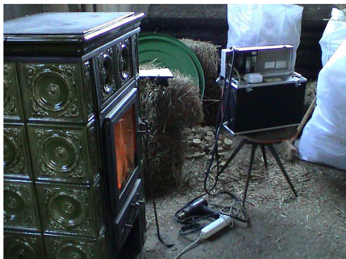
Obr. 1 Krbová akumulční kamna s jmenovitým tepelným výkonem 8 kW a měřicí aparatura s analyzátořem spalín GA 60
