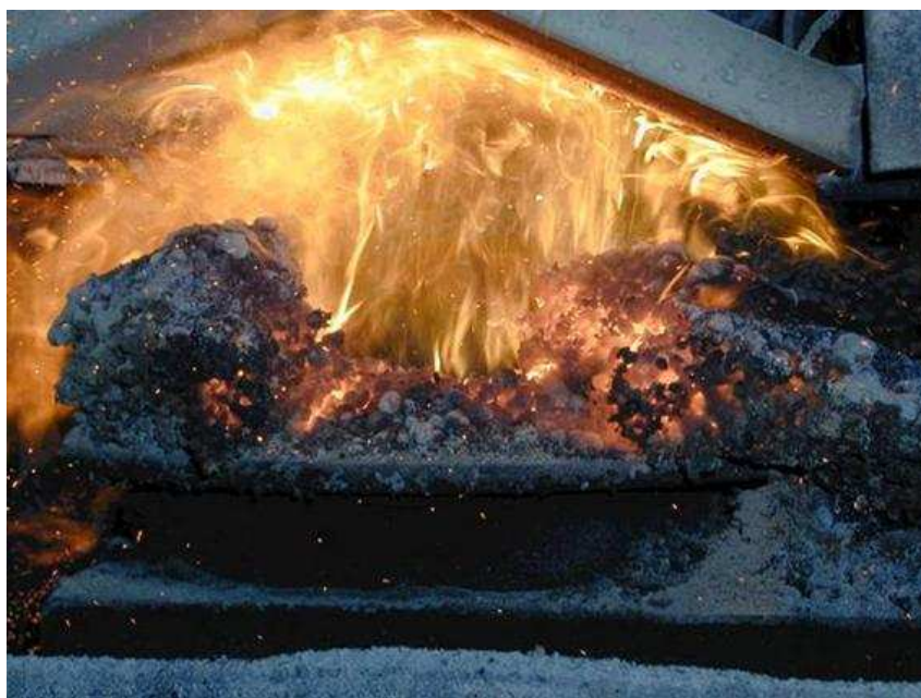
Obr. 1 Problémy se spékáním popela při spalování briket s příměsí slámy
