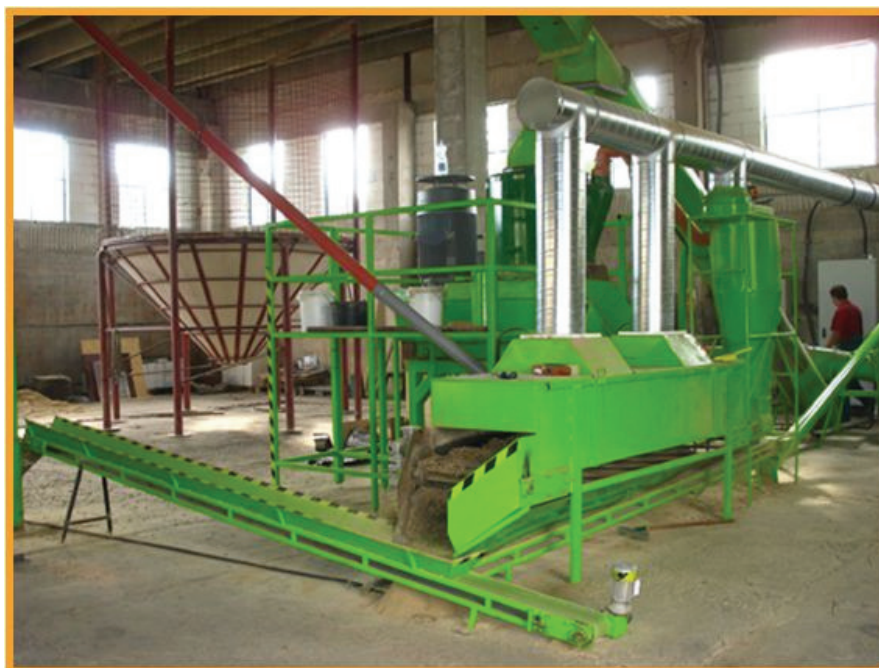
Obrázek 3.3 Technologie peletovací linky na slámu [47]
